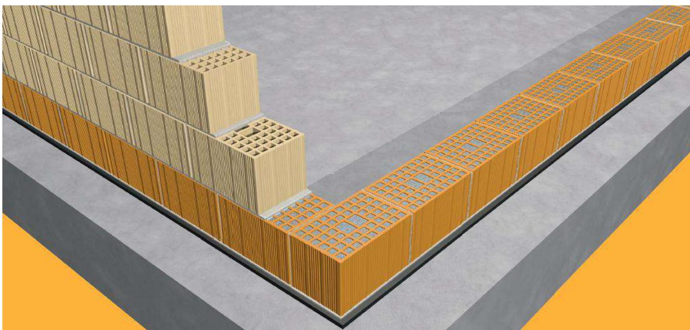
Completato il primo corso di **blocchi Normablok Più**, stendere la malta di allettamento e procedere con la posa della muratura prevista, seguendo le specifiche indicazioni del produttore.
