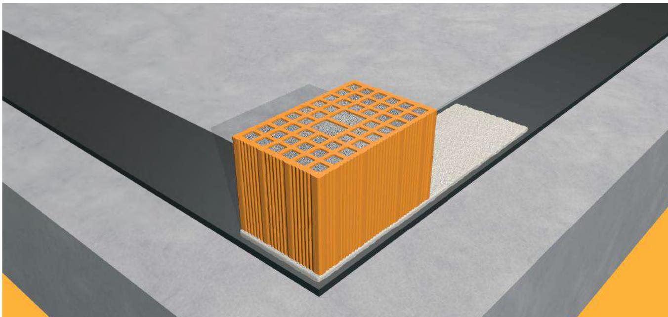
Applicata un'adeguata guaina impermeabilizzante dove richiesto, posare il corso di **blocchi Normablok Più** realizzando i giunti con malta di allettamento tradizionale. Nel caso di blocchi Normablok Più ad incastro realizzare solo il giunto orizzontale.
