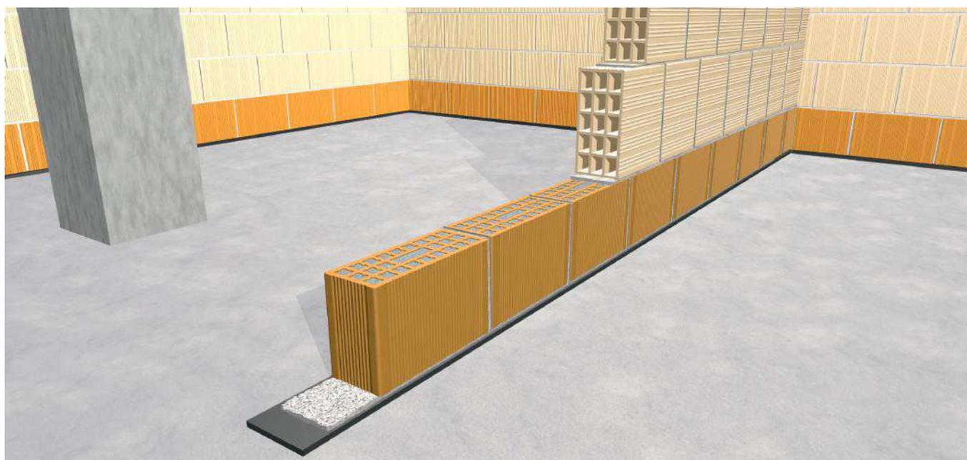
Completato il primo corso di **blocchi Normablok Più**, stendere la malta di allettamento e procedere con la posa della tramezzatura prevista, seguendo le specifiche indicazioni del produttore.
