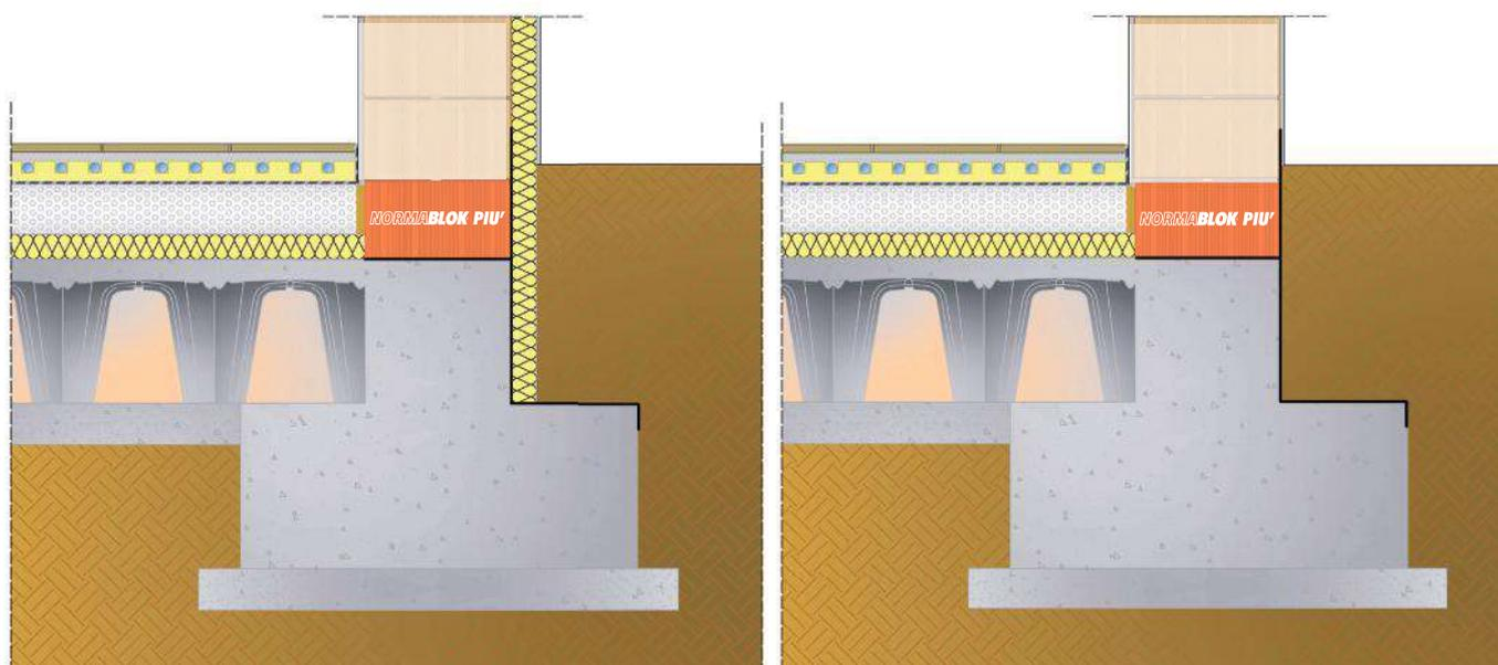
**Fondazione.** In corrispondenza dell'attacco con la fondazione, i **blocchi Normablok Più** vengono impiegati come taglio termico per realizzare il primo corso di muratura, nel caso di murature portanti o di tamponamento, con o senza cappotto termico.
