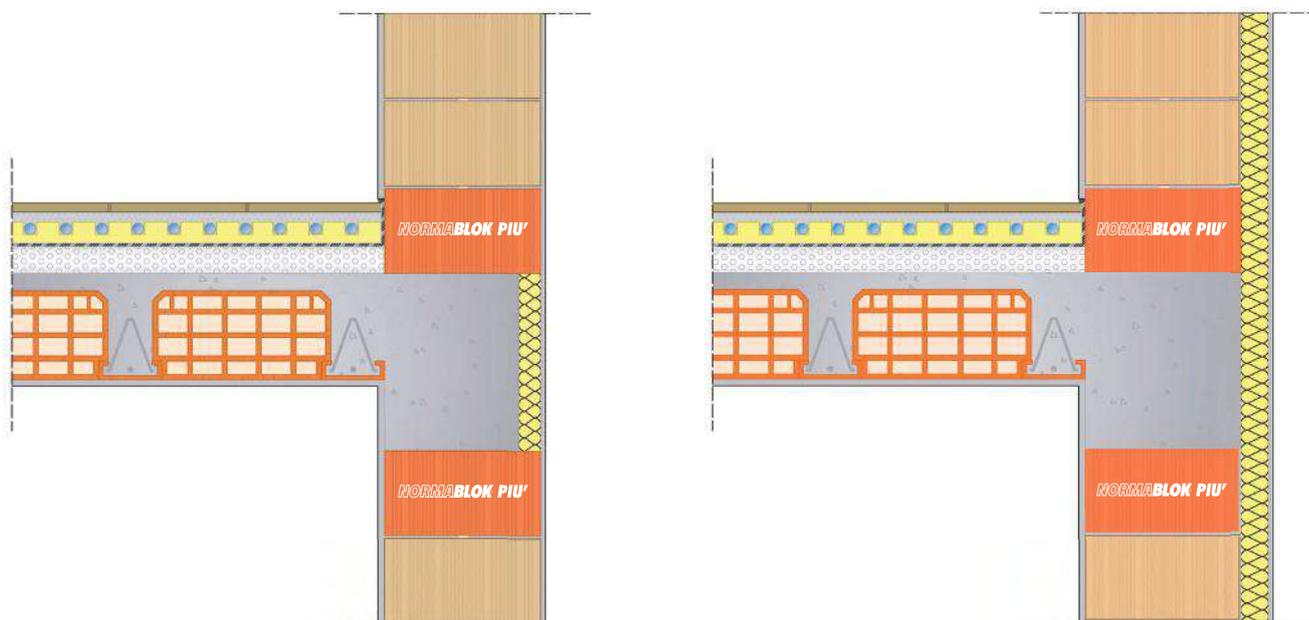
**Solaio.** In corrispondenza del solaio i **blocchi Normablok Più** vengono impiegati come taglio termico per realizzare l'ultimo corso e il primo corso di muratura rispettivamente all'intradosso e all'estradosso della trave. Sono efficaci sia per soluzioni in muratura portante che di tamponamento, con o senza cappotto.
