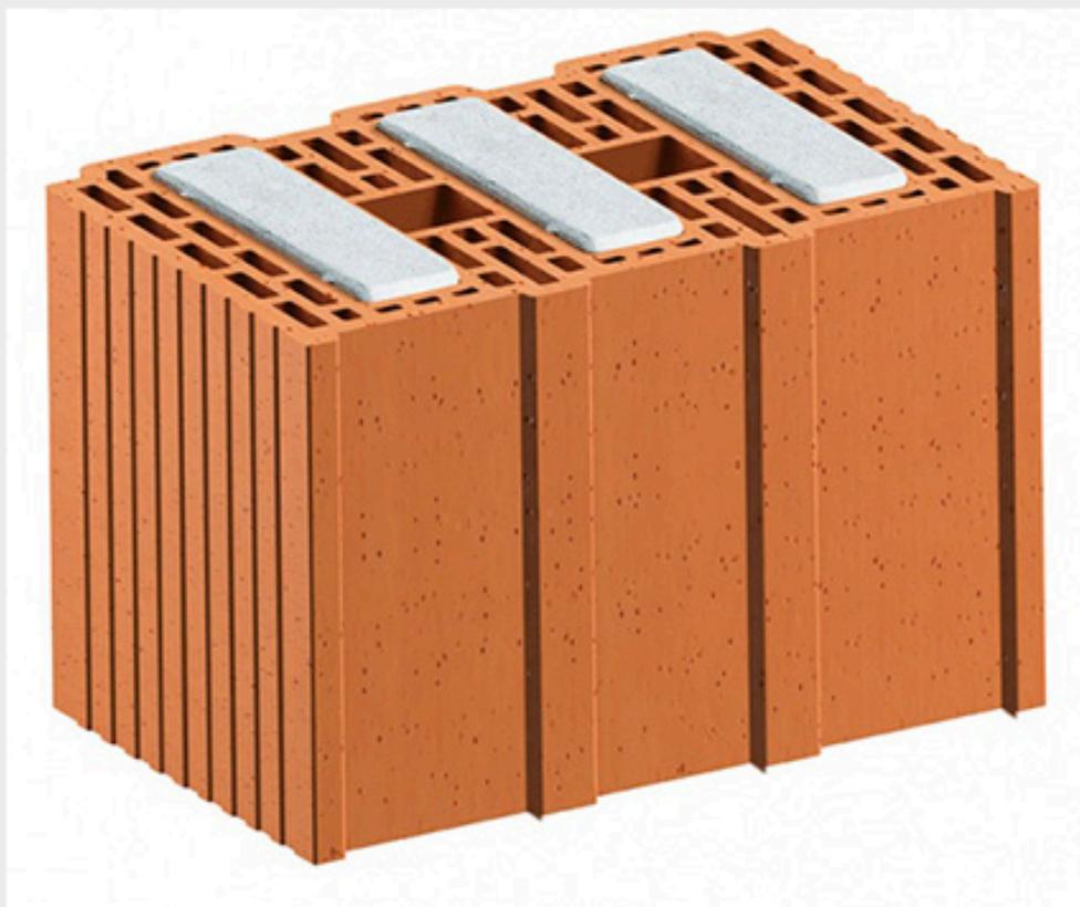
**Traspirabilità:** le fasce prive di isolante, che naturalmente si vengono a creare accostando un blocco all'altro durante la posa, permettono alla parete di mantenere una buona permeabilità al vapore, evitando la formazione di condense interstiziali.
