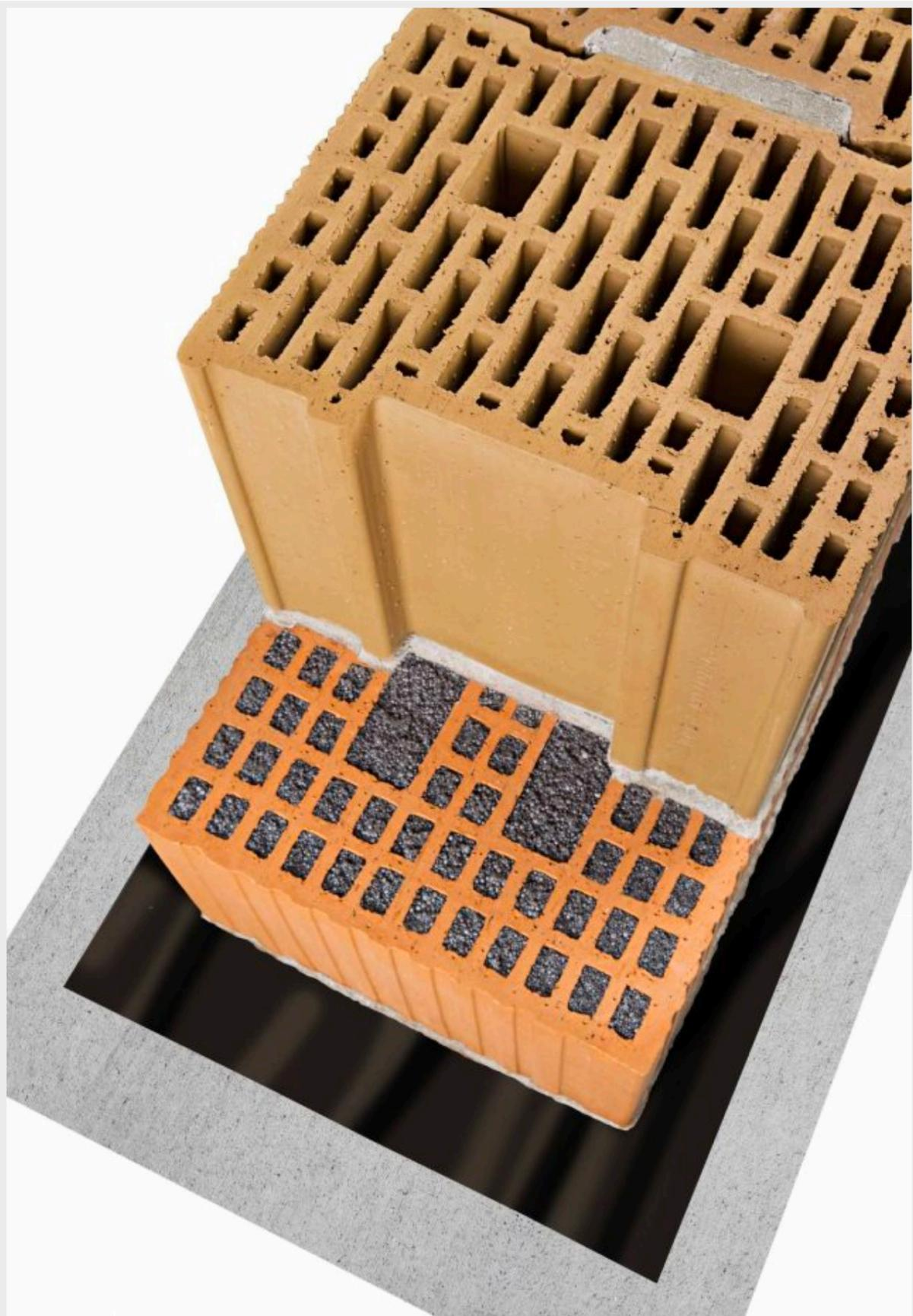
I blocchi in laterizio **Normablock Più Taglio Termico, di Danesi**, rappresentano un sistema per risolvere il problema dei ponti termici e garantire un corretto isolamento dell'involucro edilizio. I pori dei laterizi vengono saturati con polistirene additivato di grafite ad alte prestazioni.
