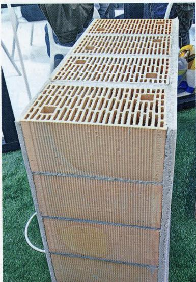
Blocco Alveolater per muratura portante monostrato, con trasmittanza di 0,30 W/m<sup>2</sup>K, proposto da Laterizi Alan Metauro.
