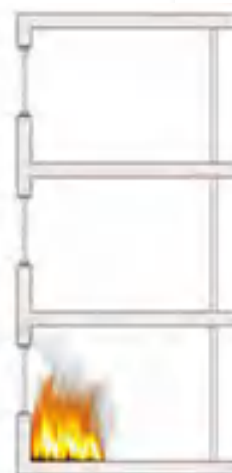
(I blocchi NORMABLOK PIÙ garantiscono sicurezza anche in caso d'incendio, evitandone la propagazione in facciata)
