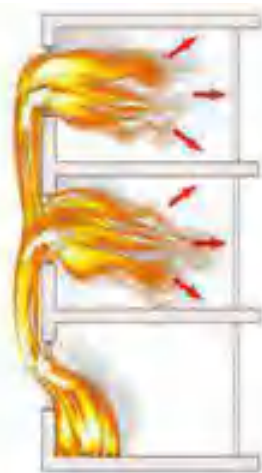
(Propagazione dell'incendio attraverso la facciata)
